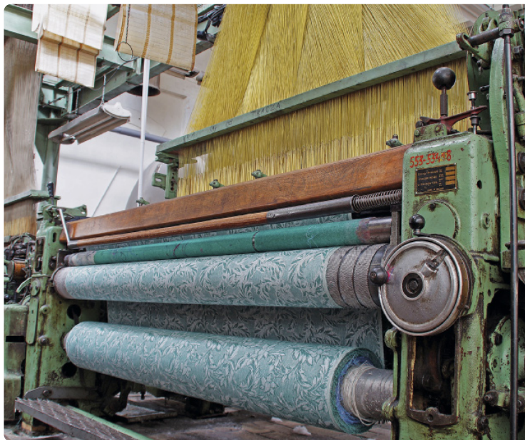
Tear de Jacquard moderno em funcionamento. Polônia, 2022.
